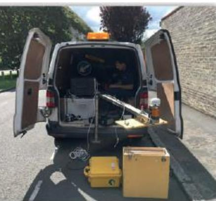
> A Rincenc ND Technologies fabrica um radar de salto de frequência com uma antena de banda larga patenteada de 0,35 Giga Hz a 3,5 Giga Hz.
