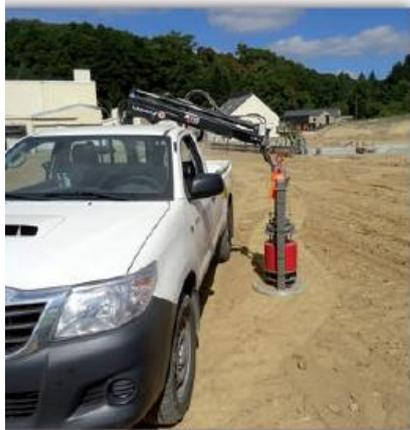
> A Rincent Ile de France Sud possui uma Dynaplaque fabricada e mantida pela Rincent ND Technologies [Tecnologias] implantada no mesmo local de Courcouronnes. Antes da entrada em serviço, o funcionamento deste equipamento é validado por um laboratório credenciado COFRAC.
