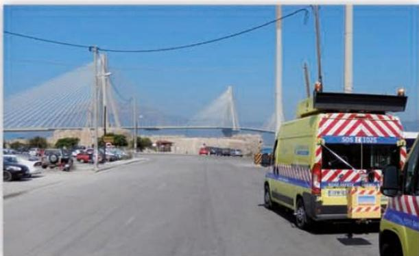
A autoestrada Atenas-Patras foi objeto de investigações se utilizando o material Radar citado anteriormente, em trechos de várias centenas de metros, para definir as estruturas de vias existentes. Os ensaios foram efetuados em várias pontes para identificar a presença ou não de membrana de estanqueidade. Essas medições eram acompanhadas por registros de vídeo.
