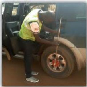
Para as rodovias não pavimentadas, o aparelho utilizado é o Bump Integrator (Roughometer III).
